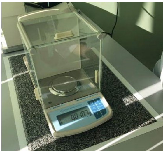
Рисунок 14 - Весы, использованные для взвешивания образца с десневой жидкостью (разрешение – 0,00001г)
