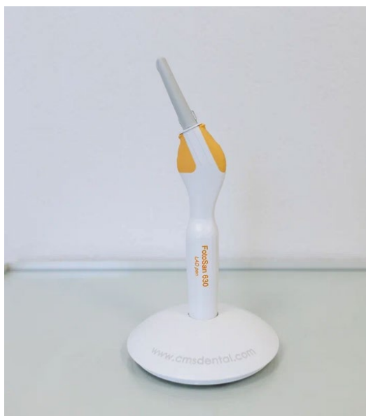
Рисунок 2 - Аппарат «FotoSan 630» для проведения ФДД
