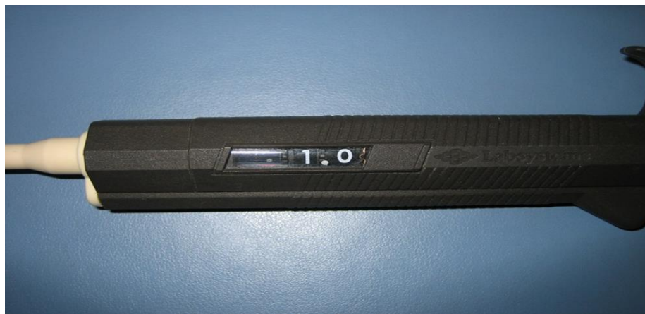
Рисунок 10 - Универсальная пипетка, содержащая автоматический дозатор (используется для нанесения приготовленного раствора)
