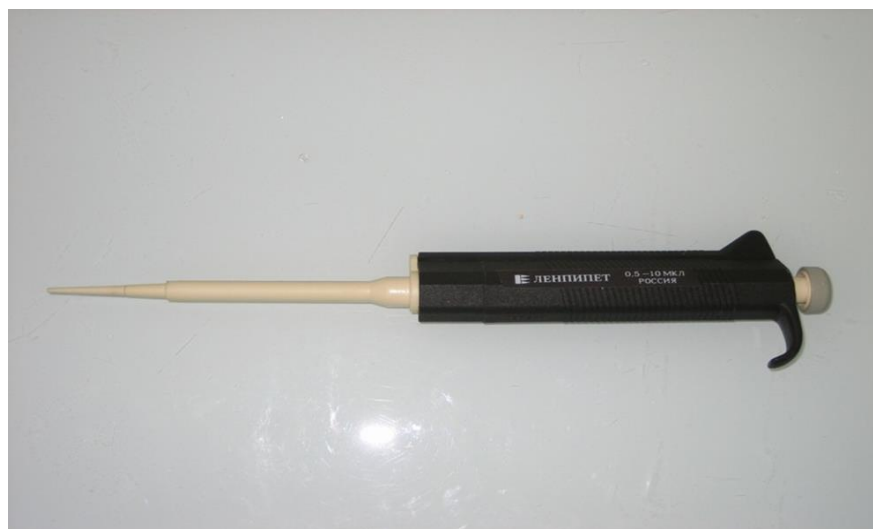
Рисунок 9 - Универсальная пипетка, содержащая автоматический дозатор (используется для нанесения приготовленного раствора)
